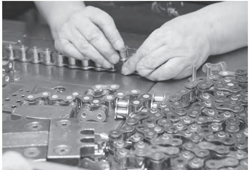
Vormontage: Sitzt hier ein Teil falsch, wirkt sich das auf die ganze Kette aus.
