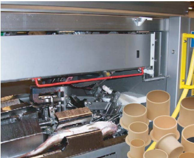
Bild PM2907-02: Wippermann Engineering, Hagen/igus GmbH, Köln Schmiermittelfreie „iglidur“-Kunststoff-Gleitlager beweisen sich bei Seewasser und Blut in Fischverarbeitungsmaschinen.
